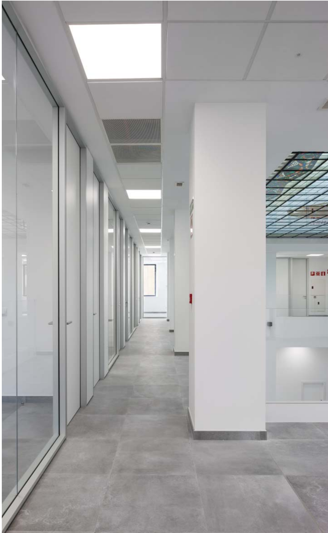
Acabados neutros en las zonas de oficinas: mamparas divisorias, pavimento de gres porcelánico rectificado y falso techo desmontable con atenuación acústica.
